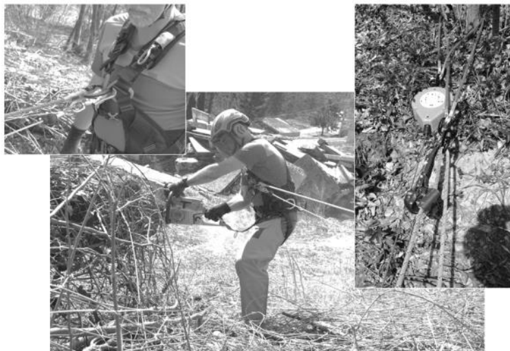
Illustration 90 : assurance avec enrouleur automatique
