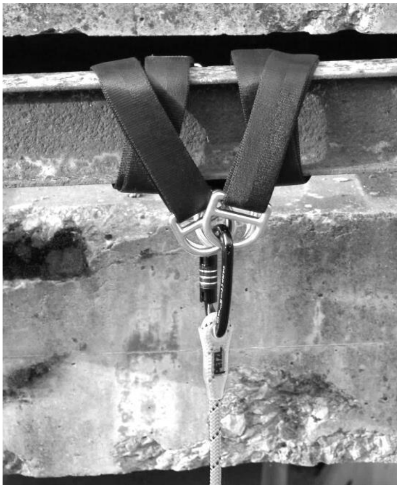
Illustration 18 : Ancrage (sangles réglables) avec tour mort
