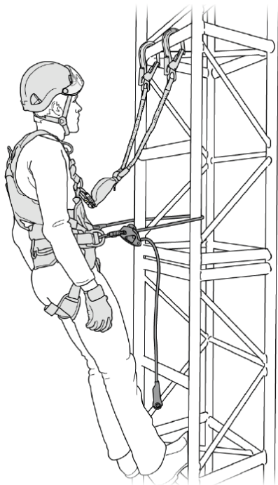
Illustration 53 : longe de maintien au travail (utilisation)
