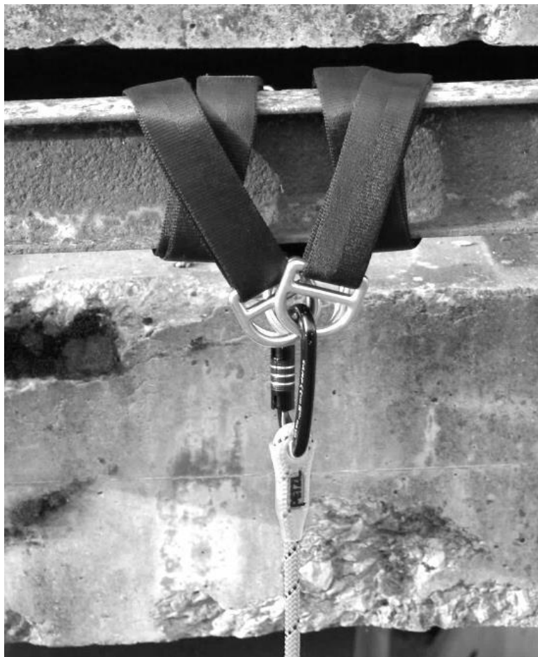
Illustration 18 : Ancrage (sangles réglables) avec tour mort
