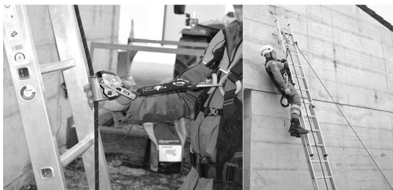
Illustration 94 : chute d'une échelle contre un mur
