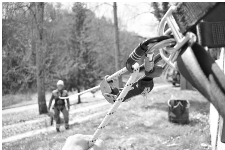
Illustration 87 : antichute mobile sur corde sur point fixe
