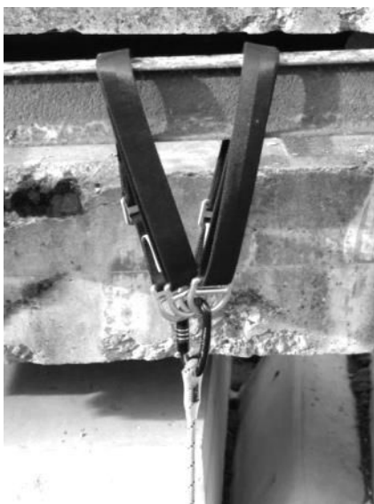
Illustration 17 : Ancrage (sangles réglables) sur un mousqueton
