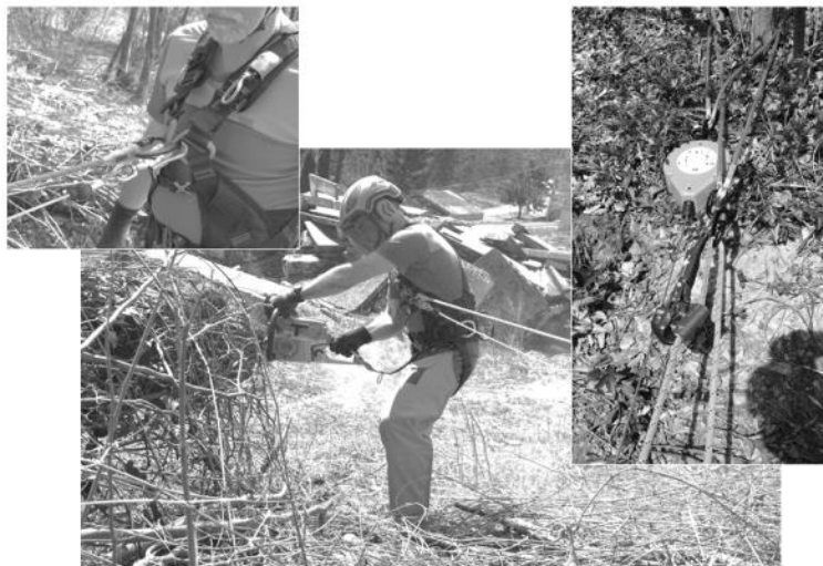
Illustration 90 : assurance avec enrouleur automatique
