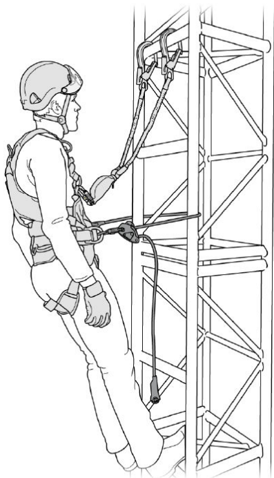
Illustration 53 : longe de maintien au travail (utilisation)
