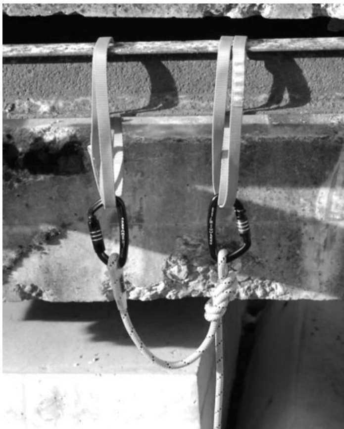
Illustration 15 : ancrage (anneaux cousus) sur deux mousquetons
