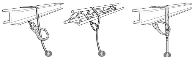
Illustration 26 : ceinture d'un ancrage
