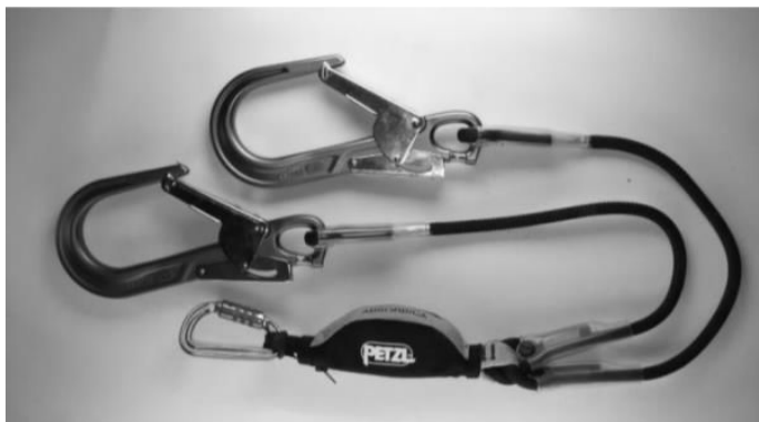
Illustration 48 : longe double avec absorbeur d'énergie
